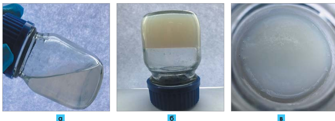
Рис. 7. Кремнийорганический состав «Пласт-СТ»: а – рабочая форма; б, в – отвержденная структура
