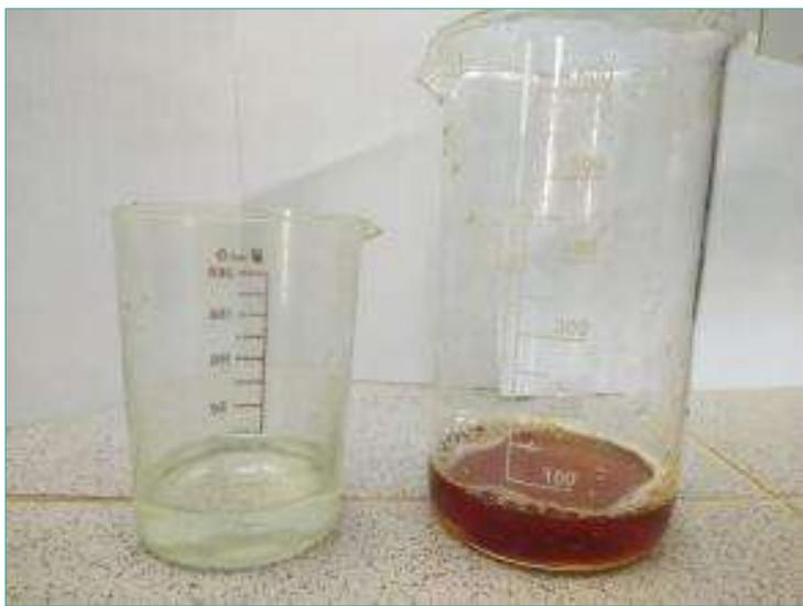
Вид двухкомпонентного термокислотного состава до реакции
