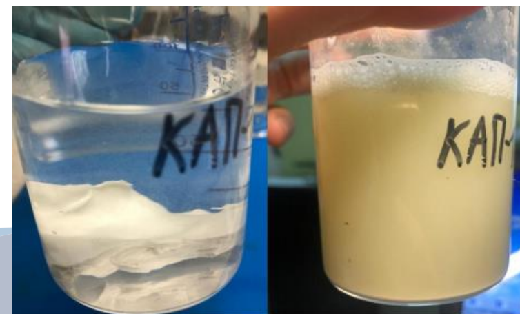
Внешний вид состава сразу после погружения в раствор деструктора КАП-1 (слева) и после термостатирования при 50°C (справа) через 2 часа.
