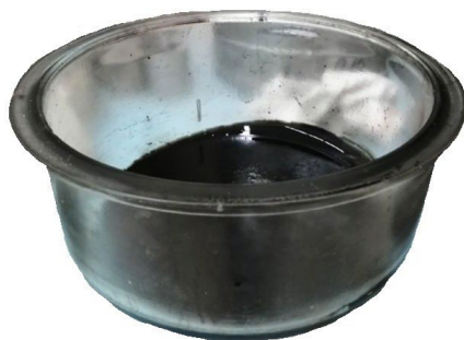
Рис. 3. Измерение нефтестойкости бетона Результаты и обсуждения
