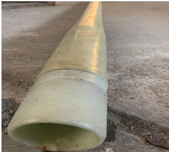
Рис. 2. Общий вид стеклопластиковых НКТ-73
