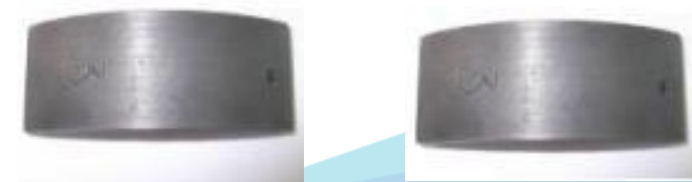
Минимальная скорость коррозии кислотного состава: от 0,05 г/м 2 *ч
