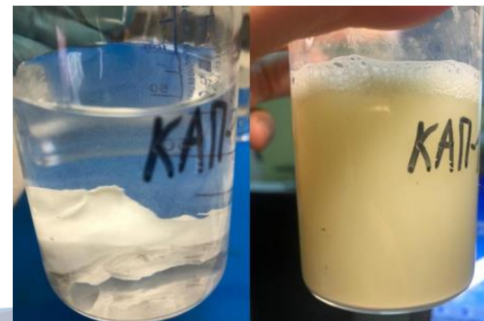
Внешний вид состава сразу после погружения в раствор деструктора КАП-1 (слева) и после термостатирования при 50°C (справа) через 2 часа.
