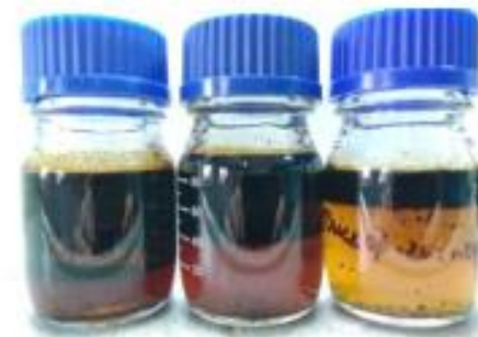
Рис.7-Внешний вид составов «Дискор 20» + нефть через 4 часа термостатирования
