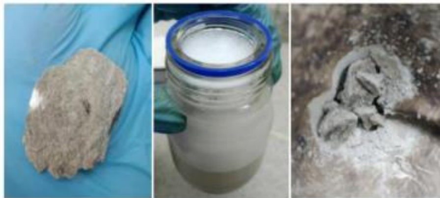
Рис.3- а) образцы ядра до растворения в кислотной композиции; б) образцы ядра в кислотных составах «Дискор 20»; в) образцы ядра после завершения испытаний
