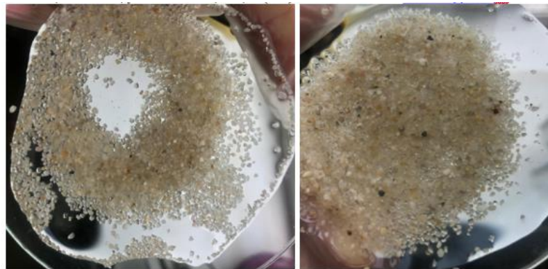
Рис.4-Кварцевый песок без гидрофобизатора (слева) и с нанесенным Гидросил м.20 (справа)
