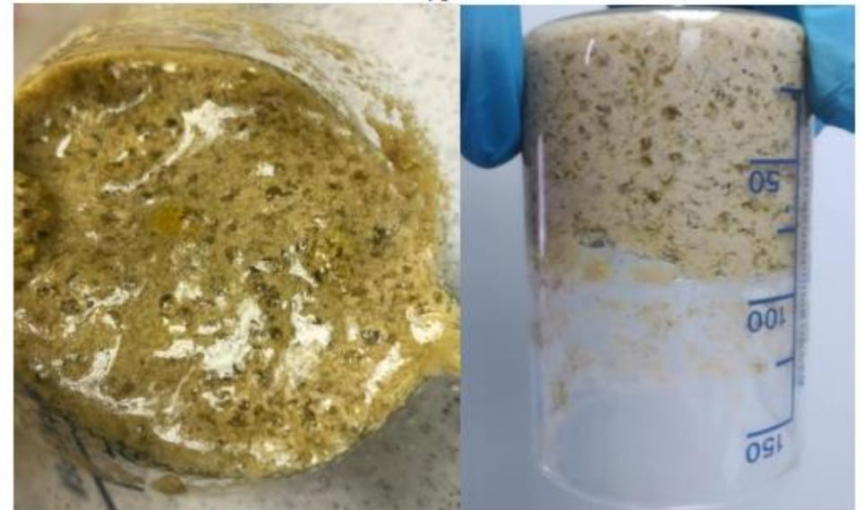
Состав сразу после приготовления и после термостатирования 12 часов
