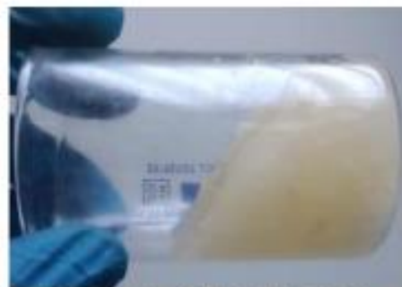
Рис.2-Внешний вид загущенной кислотной композиции «Дискор 20» с добавлением 3% «Стрим G»
