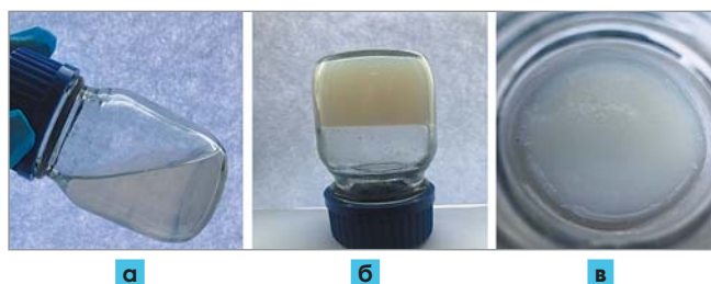
Рис. 5. Кремнийорганический состав «Пласт-СТ»:
